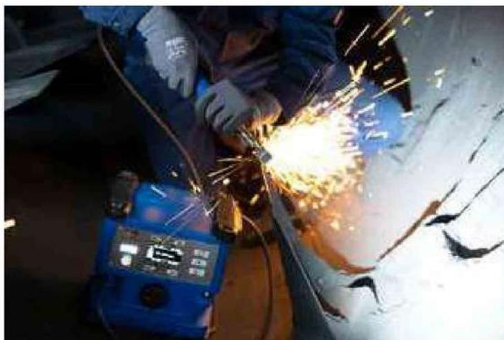
**Pferd Tools** - Il sistema di lavoro RCK per applicazioni di smerigliatura, sbavatura e lavorazioni di precisione è composto da un'unità di controllo RCK STG 10/800 che gestisce la velocità dei manipoli fornendo una potenza massima di 1.560 watt, mantenendo una velocità costante anche sotto carico e da una gamma di impugnature leggere e a bassa vibrazione.
