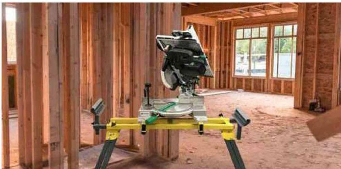
**Compa Tech** – Ecco alcune caratteristiche della trancattrice Silver-Green Mod. 250 Evolution: lama 250mm. Z.60; capacità di taglio mm. 150x70h.; potenza 1600 W.; piano superiore in alluminio pressofuso cm.40 x 30 con 3 punti di bloccaggio; interruttore unico dotato di bobina di sgancio per evitare riavvio accidentale.
