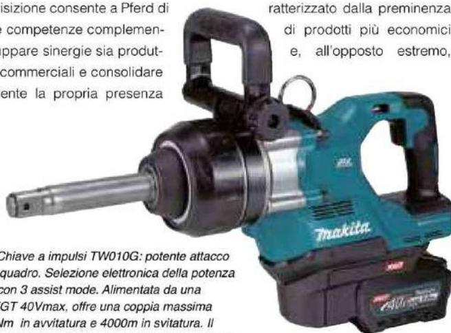
**Makita - Chiave a impulsi TW010G:** potente attacco 1" pollice quadro. Selezione elettronica della potenza a 4 stadi con 3 assist mode. Alimentata da una batteria XGT 40Vmax, offre una coppia massima di 3.150 Nm in avvitatura e 4000m in svitatura. Il motore posizionato verticalmente riduce la lunghezza complessiva della macchina e limita la forza di reazione sulla mano dell'utente, migliorando il comfort.
