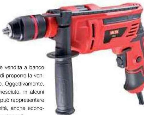
**Valex - Trapano con percussione T950** è equipaggiato con un motore da 950 W e velocità variabile con preselezione del numero di giri (0-300 giri/min, 0-48000 colpi/min). Reversibile. Il mandrino autoserrante in acciaio (Ø 1,5-13 mm) consente un cambio rapido della punta. Provvisto di asta finecorsa. Capacità di foratura: Ø 13 mm su metallo e muratura, Ø 25 mm su legno.
